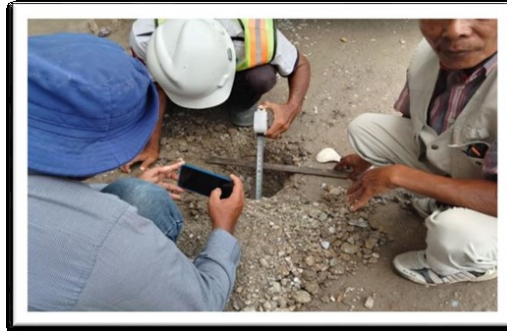
Gambar 2. Uji Dimensi dan Ketebalan Lapis Pondasi Bawah (Test Pit)
