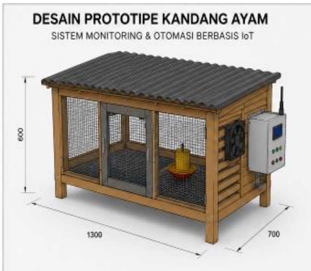
Gambar 3. Implementasi Sistem Automasi Kandang Ayam Broiler
